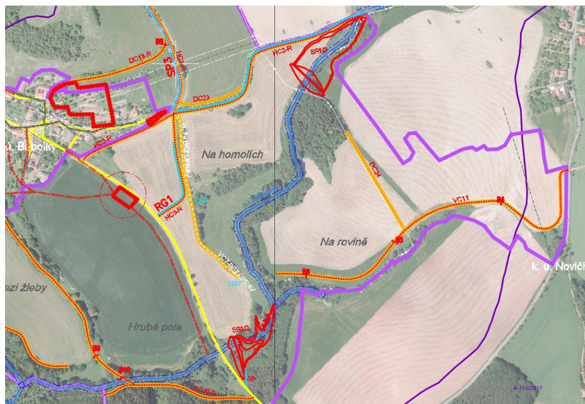
Obr. 29 - Návrh suchých retenčních nádrží projednaných se sborem zástupců
